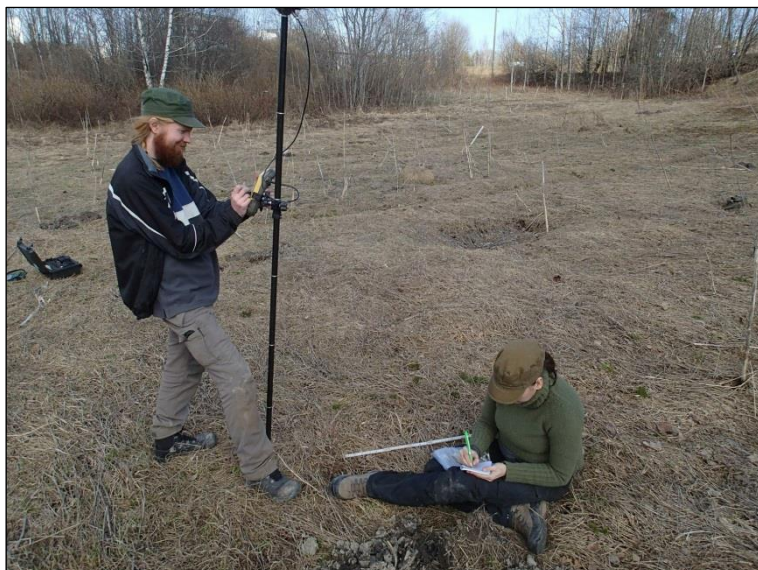
Kartoitus ja paikannusmittaukset tehtiin tarkkuus-GPS-laitteella.
